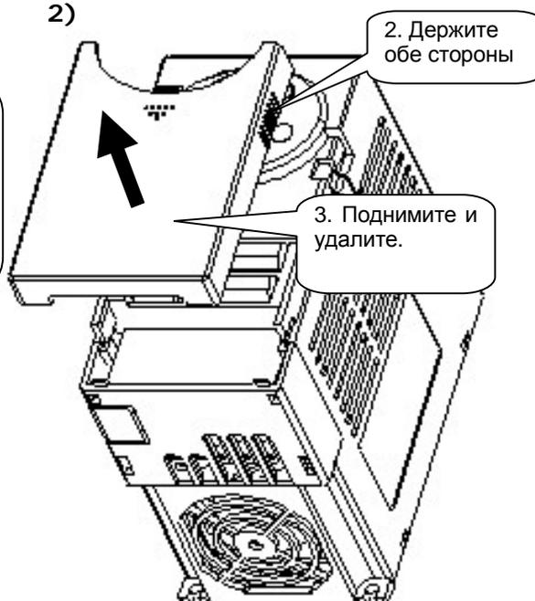
Разборка для силовых подключений: После удаления верхней крышки сдвиньте нижнюю крышку до отсоединения.
