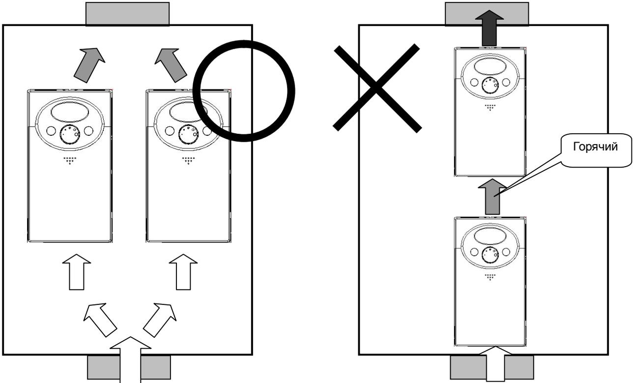
\* Внимание: Необходимо обеспечить хороший отвод тепла при установке преобразователя и вентилятора в шкафу.
