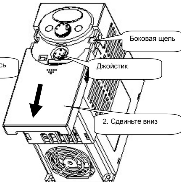
Для подключений: способ аналогичен описанному выше. Удерживая крышку с обеих сторон, снимите ее с корпуса.
