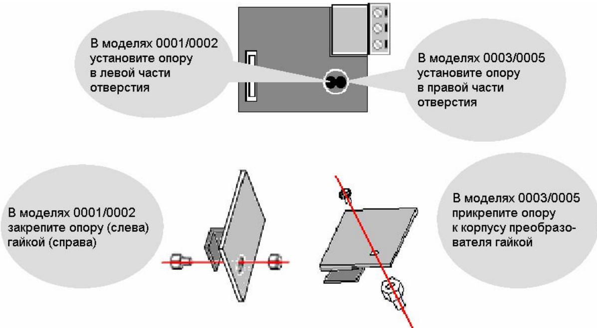
В опциональной плате имеется двойное отверстие для крепления. Левая часть отверстия используется для крепления в моделях SINUS N 0001/0002, а правая – в моделях SINUS N 0003/0005.
