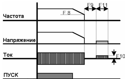
4 Установка F10 или F11 равным 0 отключает торможение постоянным током.
