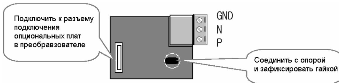
Рис. 1. Расположение разъемов
