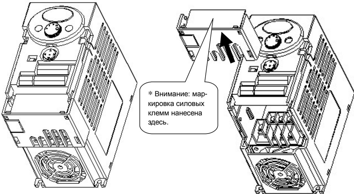
Для доступа к клеммам управления: после подключения силовых кабелей установите нижнюю крышку на место и начните подключение кабелей управления.
